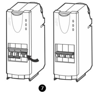
**Hinweis:** Manche PDMs verfügen über eine besondere Klappe, die alle Leitungsschutzschalter gleichzeitig abschaltet, wenn sie in die Stellung AUS versetzt wird. Diese Klappe kann anschließend wieder in ihre Ausgangsstellung zurück bewegt werden, um einzelne Leitungsschutzschalter in die Stellung EIN versetzen zu können.
