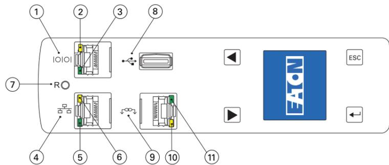
An der Vorderseite der ePDU befinden sich Kommunikations- und Überwachungsports, LED-Statusanzeigen und Bedientasten. Die Ports und die entsprechenden LED-Anzeigen werden in der nachfolgenden Tabelle beschrieben.
