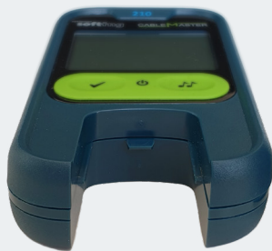
Abnehmbare Remoteeinheit mit RJ45 Port
