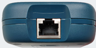
RJ45 Test-Port (Koax über optionalen Adapter)
