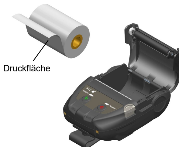
Abbildung 9-2 Einsetzen des Thermopapiers
