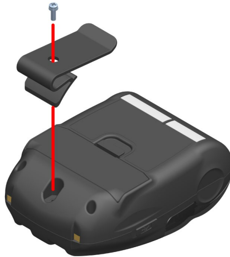
Abbildung 13-1 Befestigen/Entfernen des Gürtelclips
