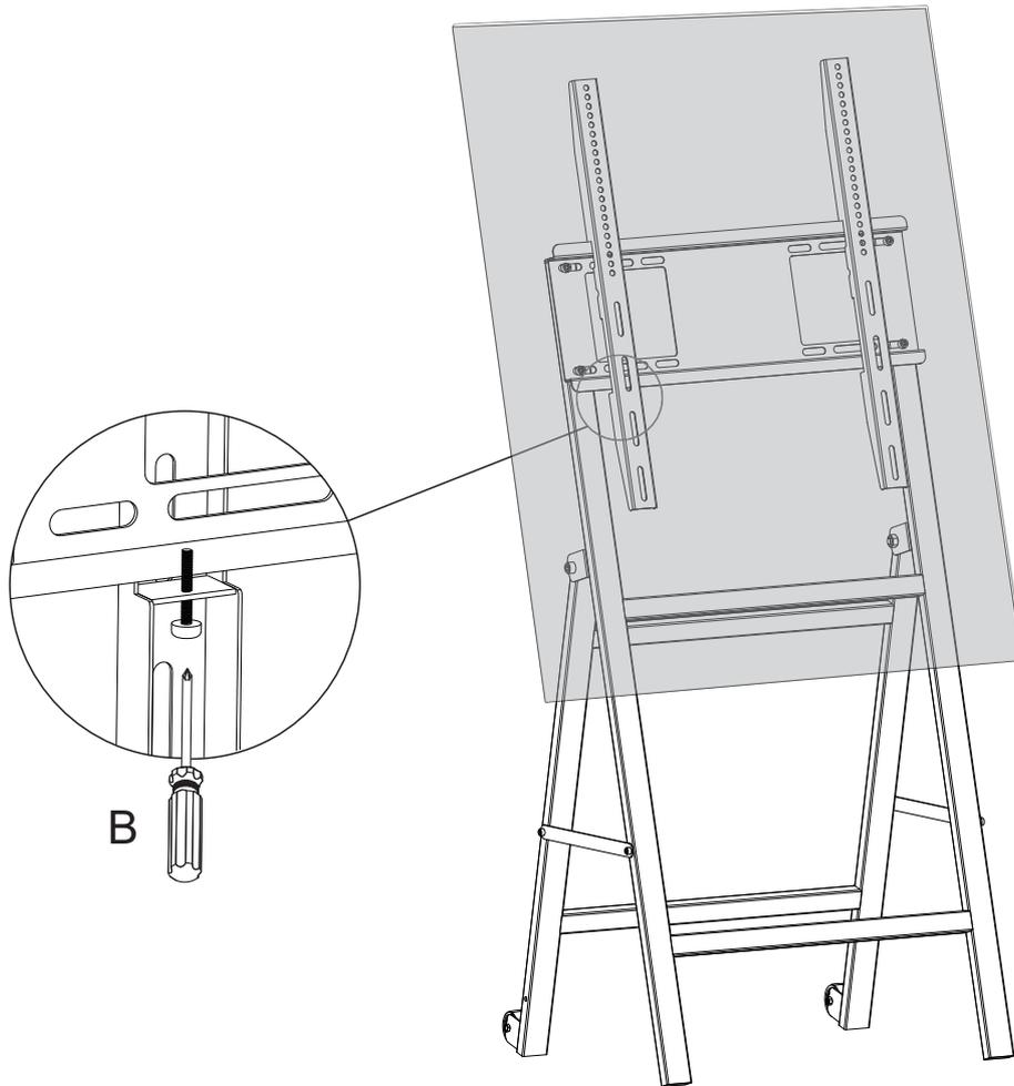
Ziehen Sie die Sicherungsschraube an der Unterseite jedes VESA-Arms fest.
