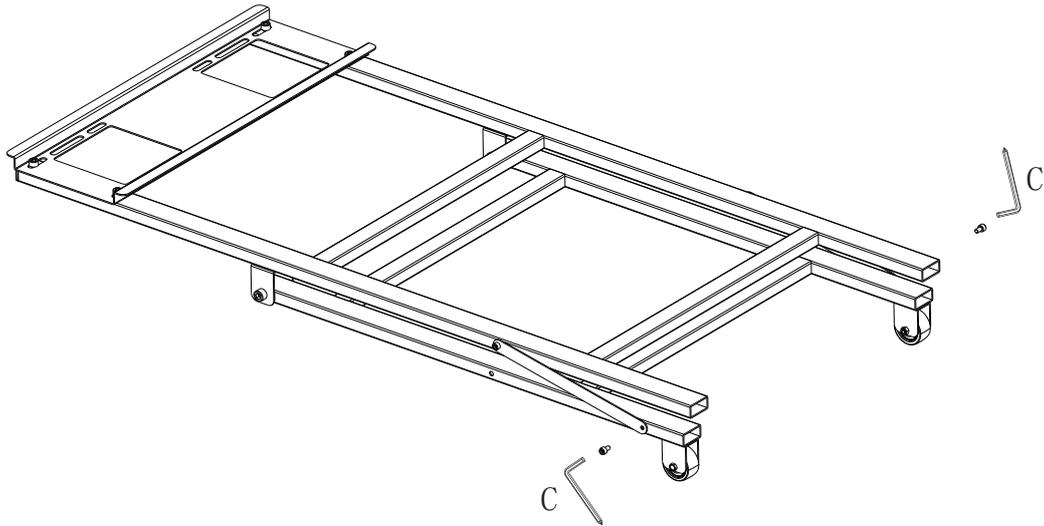
Lösen Sie die Schrauben mit dem Inbusschlüssel (C).
