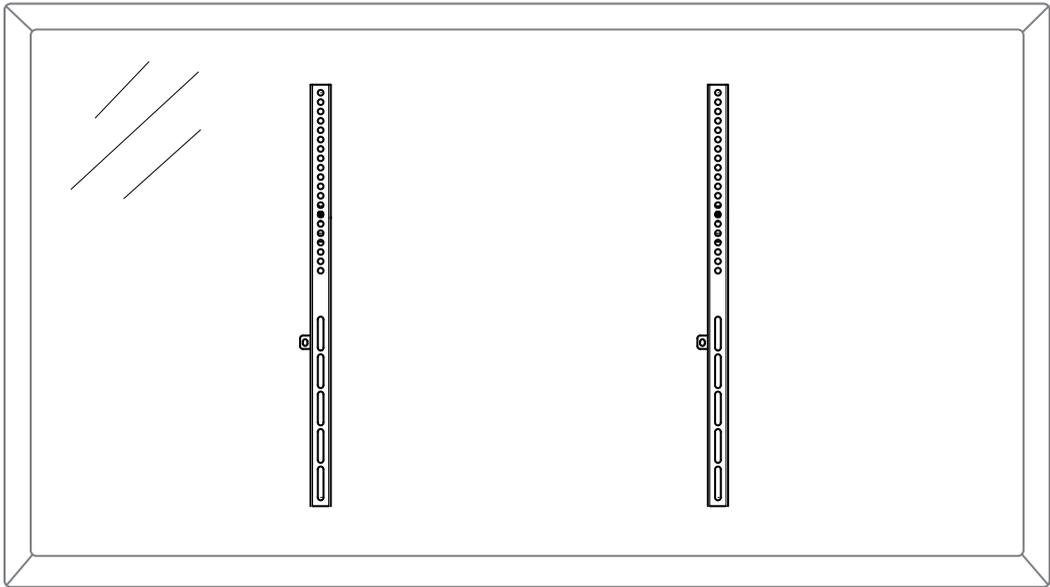
Montieren Sie die VESA-Arme rückseitig am Bildschirm. Schrauben bitte vorsichtig einschrauben und anziehen um Beschädigungen zu vermeiden. Verwenden Sie passende Schrauben aus dem mitgelieferten TV-Schrauben-Beutel.
