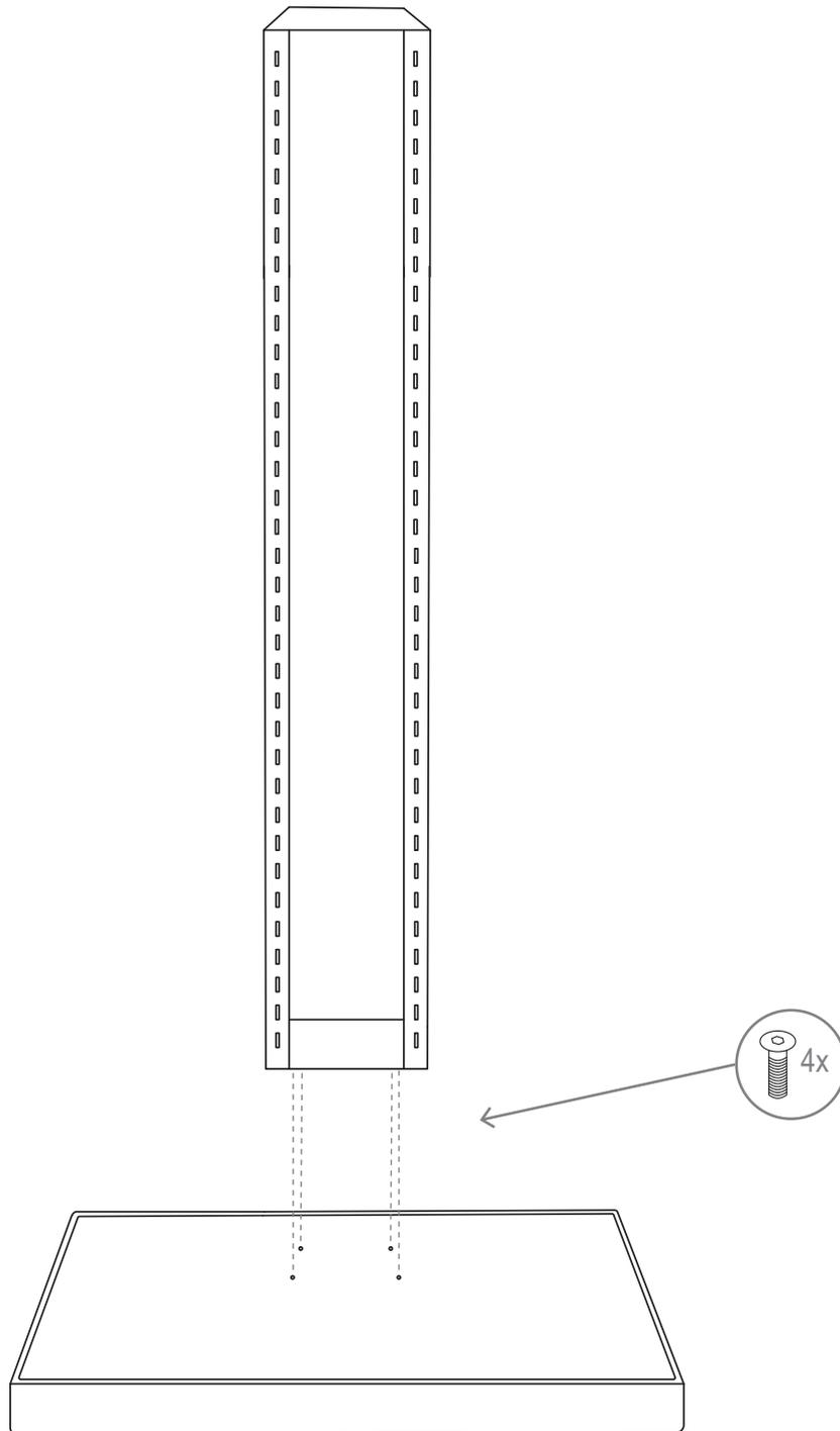
Legen Sie die Standsäule auf eine weiche Unterlage um Beschädigungen zu vermeiden. Verschrauben Sie die Bodenplatte mit der Standsäule, verwenden Sie hierfür die M8X40 Senkkopfschrauben. Richten Sie die Säule anschließend vorsichtig auf.
