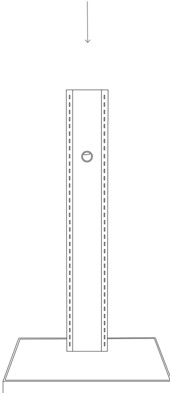
Verlegen Sie innerhalb der Säule alle benötigten Kabel und schieben Sie anschließend die Frontblende und die rückseitige Abdeckung vorsichtig von oben in die Säule ein. Vermeiden Sie es die Blenden zu verkanten um Beschädigungen zu vermeiden.
