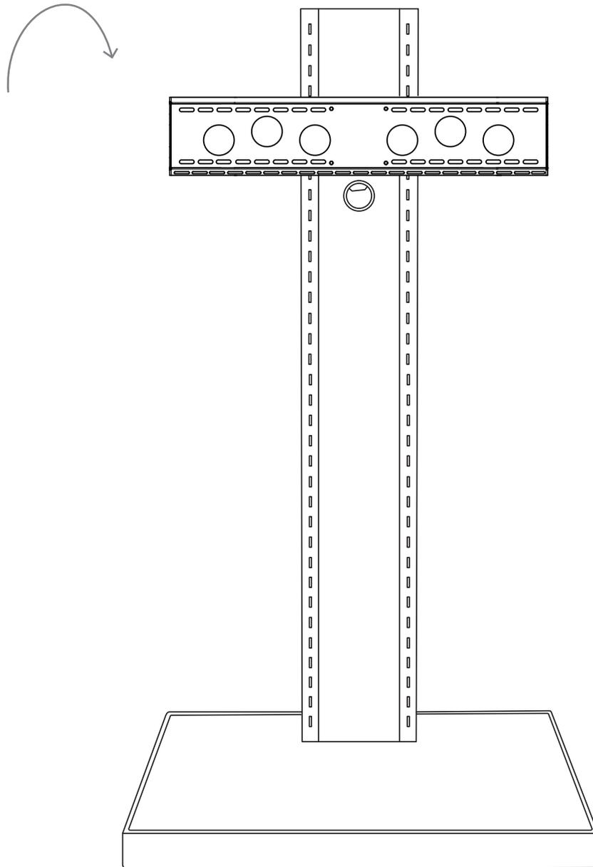
Hängen Sie die VESA-Aufnahme / VESA-Montageplatte in der gewünschten Höhe in die Raststufen der Säule ein.
